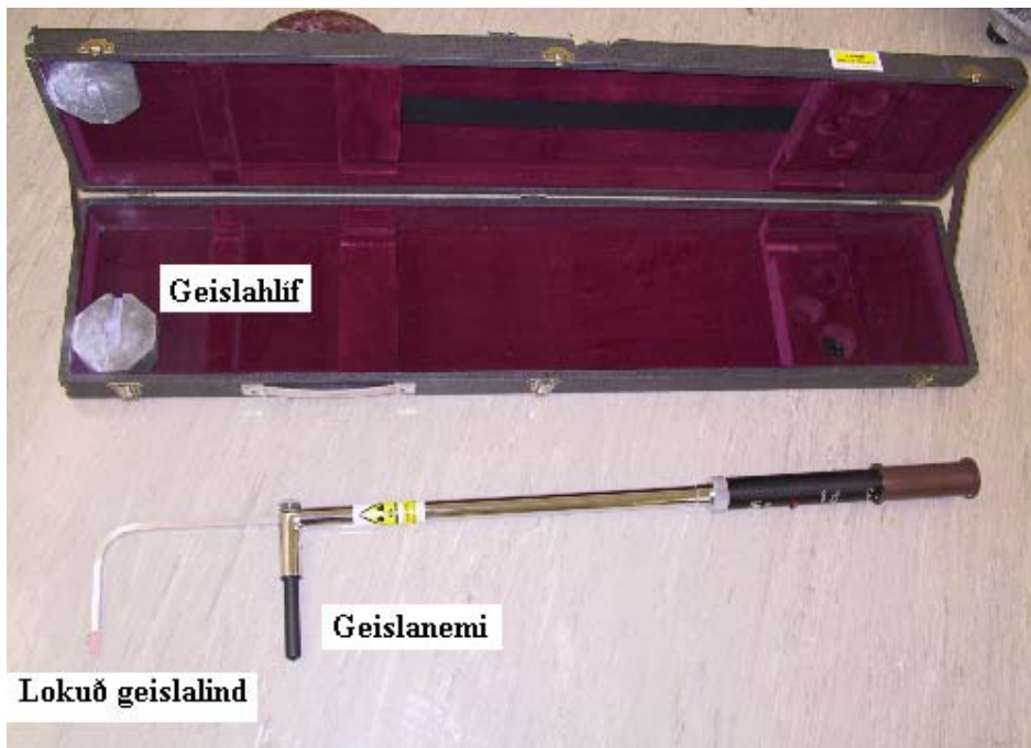
Mynd 2: Færanlegur áfyllingarmælir (geislagaffall) í geymslu hjá Geislavörnum ríkisins. Í þessum geislagaffli er geislavirka efnið ^{137}\text{Cs} .
