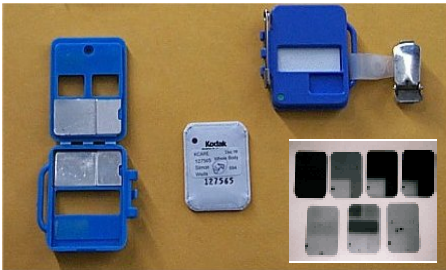
Mynd 1. Filmuhylki og mælifilma. Sýnishorn af framkölluðum filmum sem bera merki geislunar
